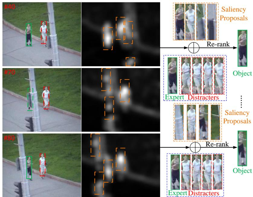
图 7 基于显著性目标候选集的多通道相关滤波跟踪系统框图
